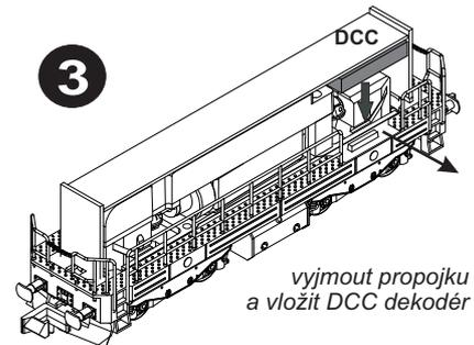
vyjmout propojku a vložit DCC dekodér
